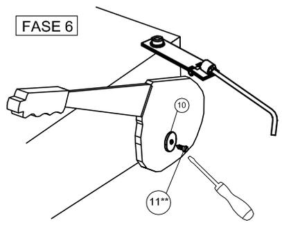
NOTA: 11\*\*VITE AUTOFORANTE (NON NECESSITA DI PREFORO)
